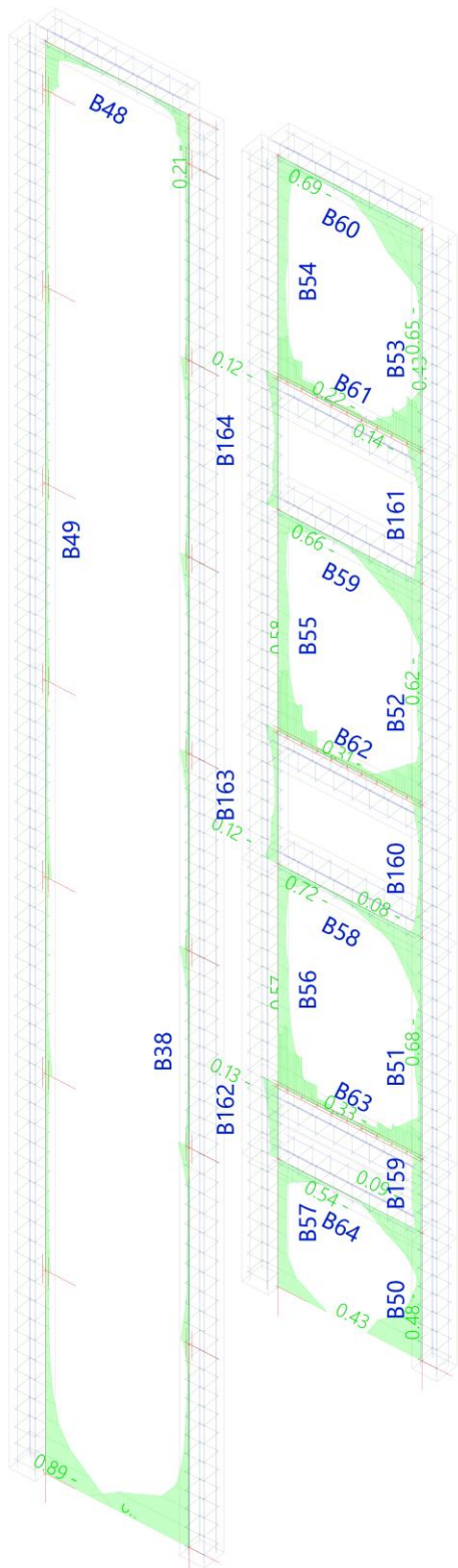
Monolitinių GB ruožų (rėmų) laikomosios gebos skersinei jėgai patikra
