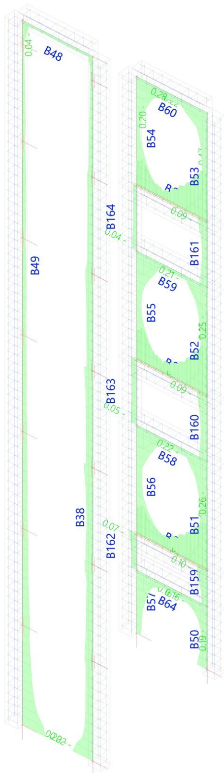
Monolitinių GB ruožų (rėmų) laikomosios gebos patikra
